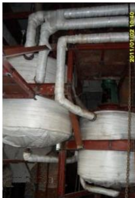
図 8. 加熱熔融装置と熔融液ポンプ写真
